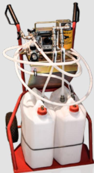
Amadio ha realizzato per tutti gli operatori del **settore aria condizionata**, con particolare attenzione al settore **autobus e ferroviario**, una **stazione di lavaggio portatile** ed efficiente per risolvere tutti i problemi legati alla pulizia degli impianti AC e HVAC anche di grosse dimensioni.
